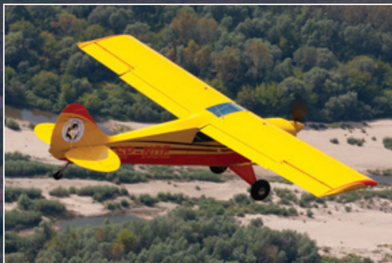
Zdjęcie po lewej: Widoczność do góry znakomicie poprawia przeszklenie przestrzeni nad głową.
