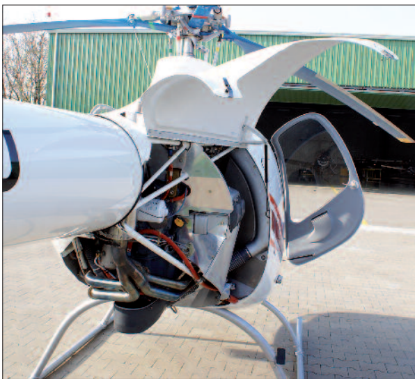
Omaskowanie silnika udostępnia szybki i pełny dostęp inspekcyjny i naprawczy
