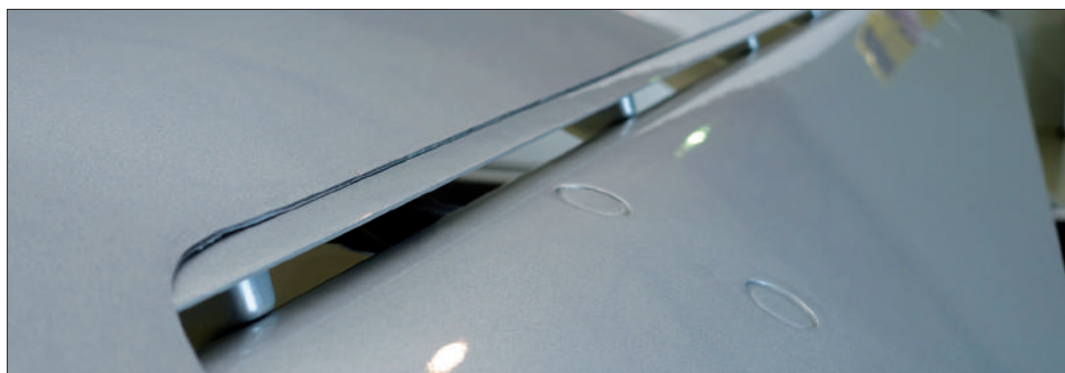
Nowością w konstrukcjach Diamonda są dwuszczelinowe klapy skracające długość startu i lądowania
