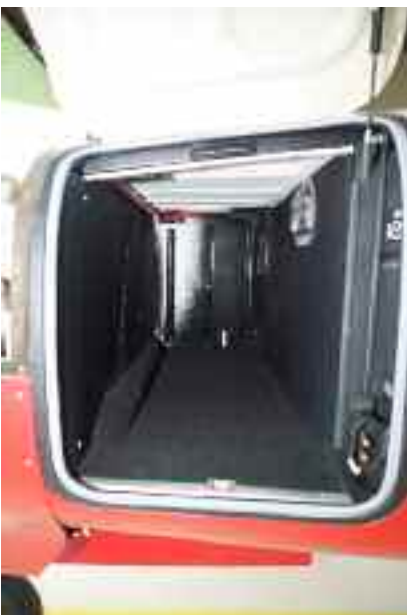
Bagażnik na 45 kg separuje dodatkowo silnik od kabiny.
