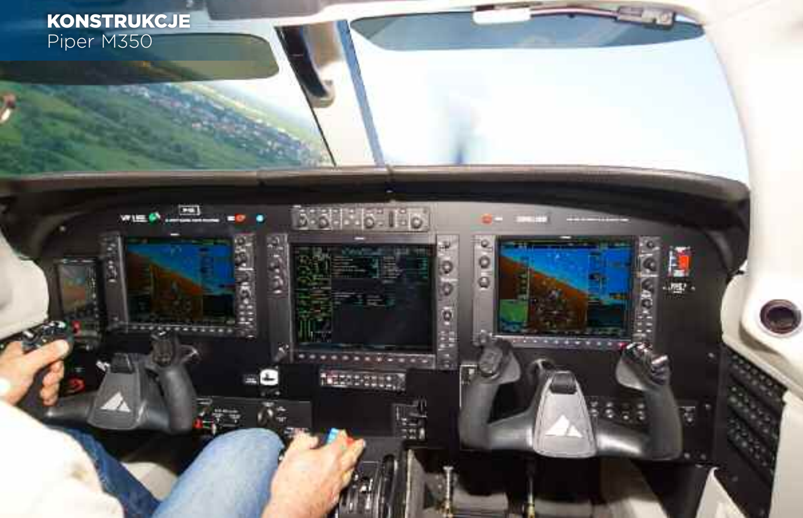
Standardowe wyposażenie stanowi Garmin G1000 - dwa wyświetlacze podstawowe (PFD) 10,4" i centralny wyświetlacz wielofunkcyjny (MFD) 12,4" oraz autopilot GFC 700 i transponder GTX 335R
