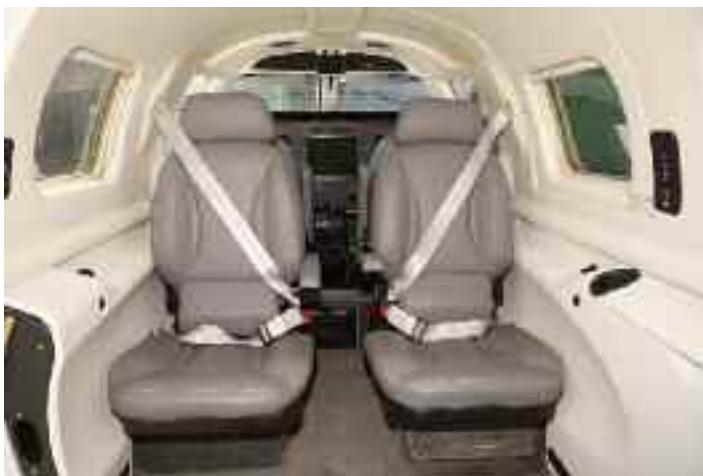
Dzięki oddzieleniu kabiny od przedziału silnikowego przednim bagażnikiem w trakcie lotu jest w niej nadzwyczaj cicho
