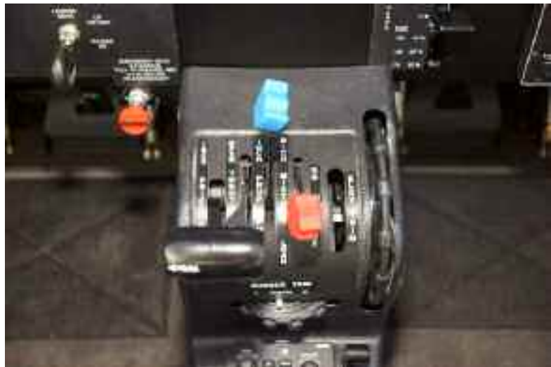
Mechanizm sterowania mocą klasyczny, z trzema dźwigniami: gazu, skoku i mieszanki
