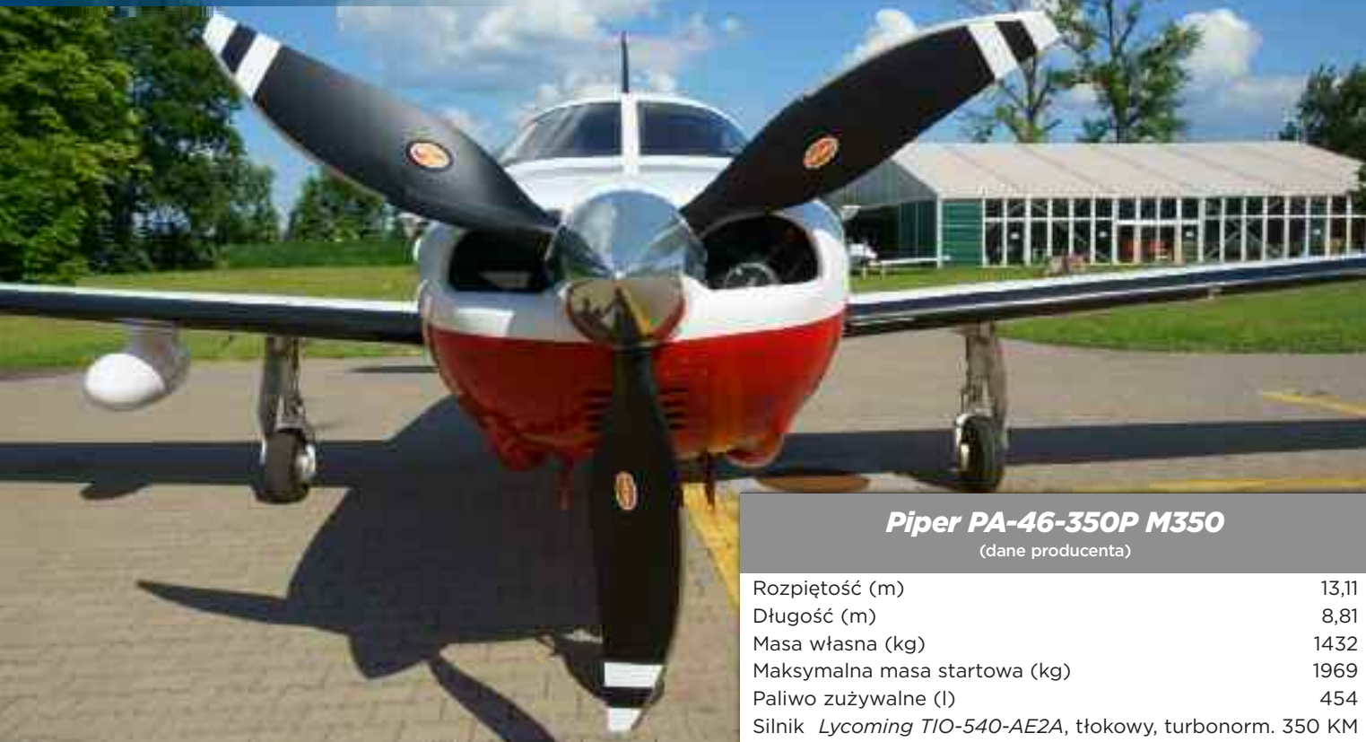
Śmigło Hartzel o szablanych łopatkach zdradza, że samolot lata szybko i wysoko
